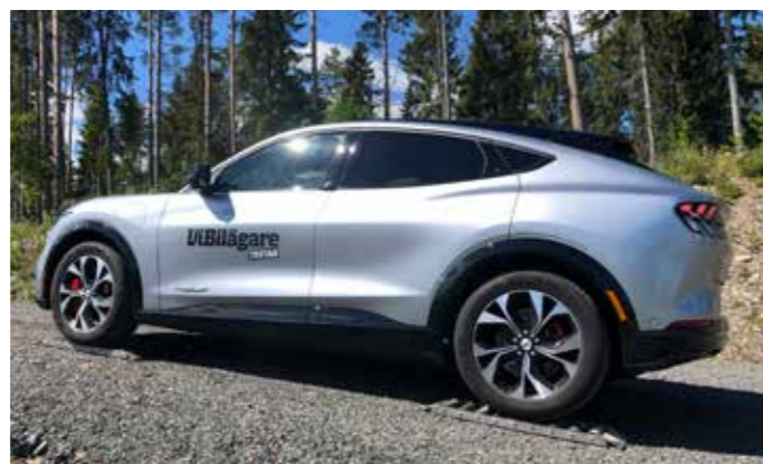
Ford, Polestar och Volvo har en elmotor på varje axel. Mustangs system reagerar långsammare och får problem när nollfriktionsrullar sätts på samma sida fram och bak eller diagonalt. Volvo/Polestar klarar det galant.
