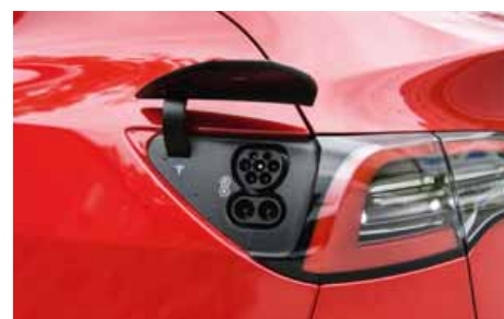
► Stöd för 250 kW-laddning och laddlucka som öppnas elektriskt och stängs automatiskt efter laddning.
